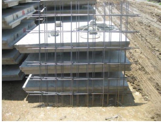
รูปที่ 4.2 ตะแกรงเหล็กข้ออ้อยขนาดเส้นผ่านศูนย์กลาง 6 มิลลิเมตร ใช้เป็นเหล็กเสริม
