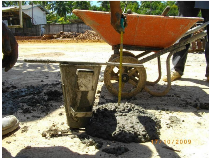
รูปที่ 4.5 การทดสอบหาค่าการยุบตัวของคอนกรีต
