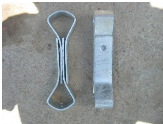
รูปที่ 4.3 อุปกรณ์สมอยึดรั้งแผง Concrete panel กับวัสดุเสริมแรง
