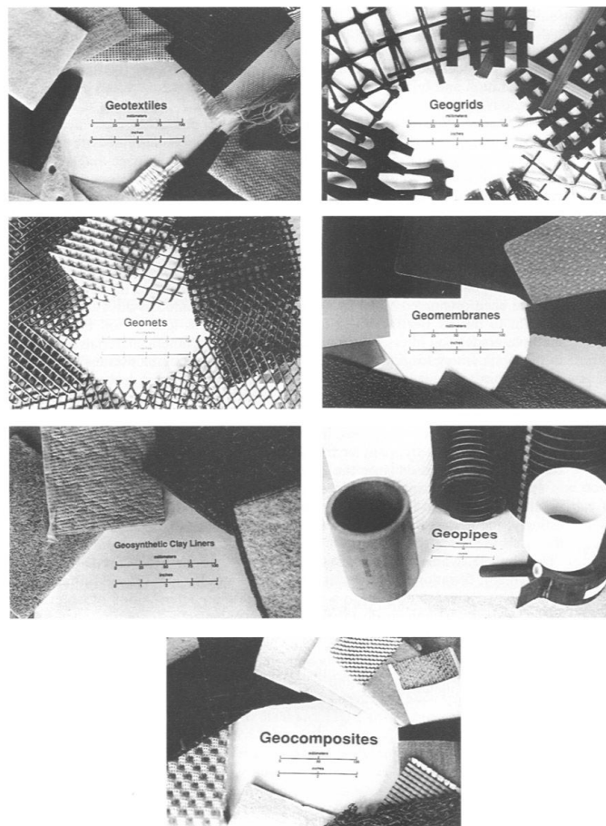
รูปที่ 2.1 ประเภทวัสดุเสริมแรงชนิดใยสังเคราะห์ (Koerner, 1998)
